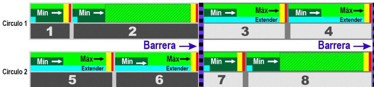
**Funcionamiento STD8: Retiradas mín en las fases 1, 2, 7 y 8 y Retiradas máx en las fases 3, 4, 5 y 6**
