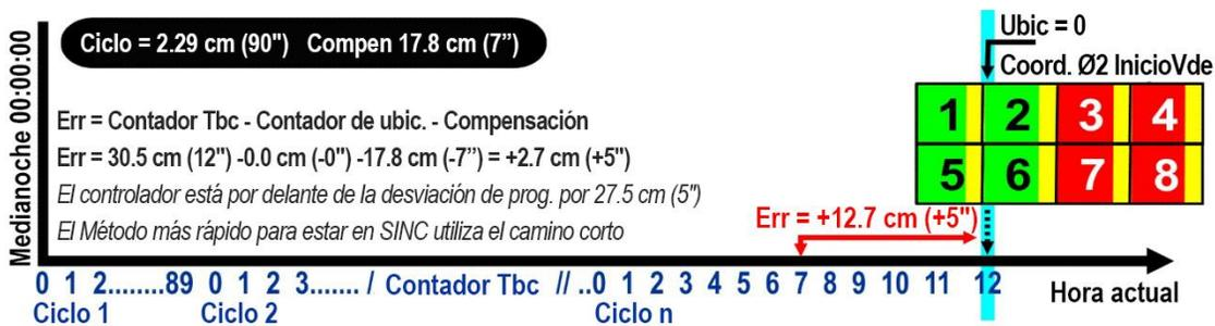
**la transición de paso-CORTO mueve la compensación “Atrás en tiempo” con una Reducción de tiempos de división por el % de paso-corto**
