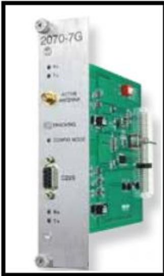
La interfaz GPS para el 2070 es idéntica a la operación del ATC que se trató en la última sección, con la excepción de la configuración del puerto com.
