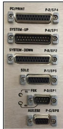
Los *Parámetros de puerto de comunicaciones* bajo del menú MM->6->2 (menú a la derecha), permiten cambiar la configuración predeterminada de velocidad de transmisión y el FCM (modo de control de flujo) de los ocho puertos seriales del 2070. Esta programación anula la configuración predeterminada de la tasa de baudios mostrada a la derecha cuando se reinicia el 2070.
